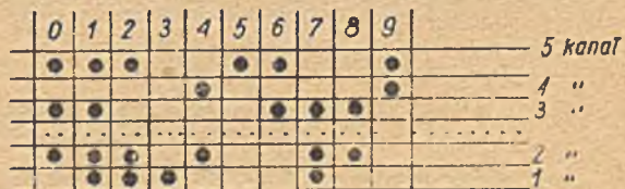
Rys.43. Cyfry od 0 do 9 wydziurkowane na taśmie 5-kanałowej
