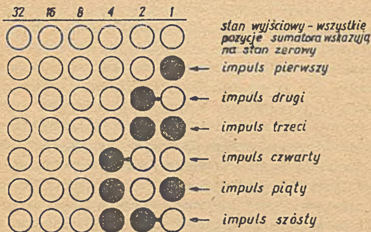
Rys.11. Sumator dwójkowy. Impuls przesłany do pozycji zmienia stan sumatora na przeciwny
