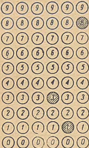
Rys.10. Przedstawienie cyfr za pomocą zapalenia lamp elektrycznych. Na rysunku pokazano zapis liczby 318
