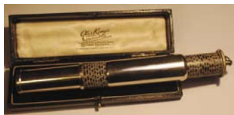
Otis King (Model A, 1920) – suwak logarytmiczny, którego skala po rozwinięciu ma długość 1.5 m.
