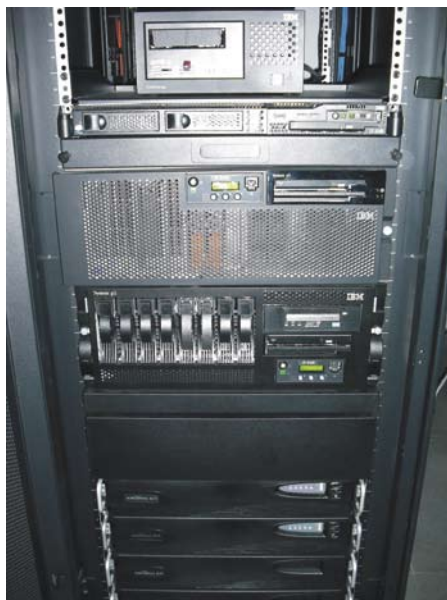
Fot. 20. Zestaw komputerowy IBM p5 (modele p570 i p520Q) z procesorami POWER5+, konsola zarządzania HMC i zasilacze awaryjne
