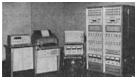
ELWAT-64 Polski komputer analogowy skonstruowany w Wojskowej Akademii Technicznej. Produkowany w Elwro.
