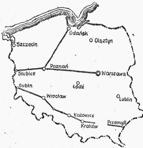
Rys. 23. 1 Główne kable dalekosiężne na sieci PKP.
