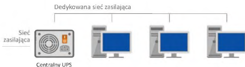
Rys. 13. Centralny system zasilania awaryjnego
