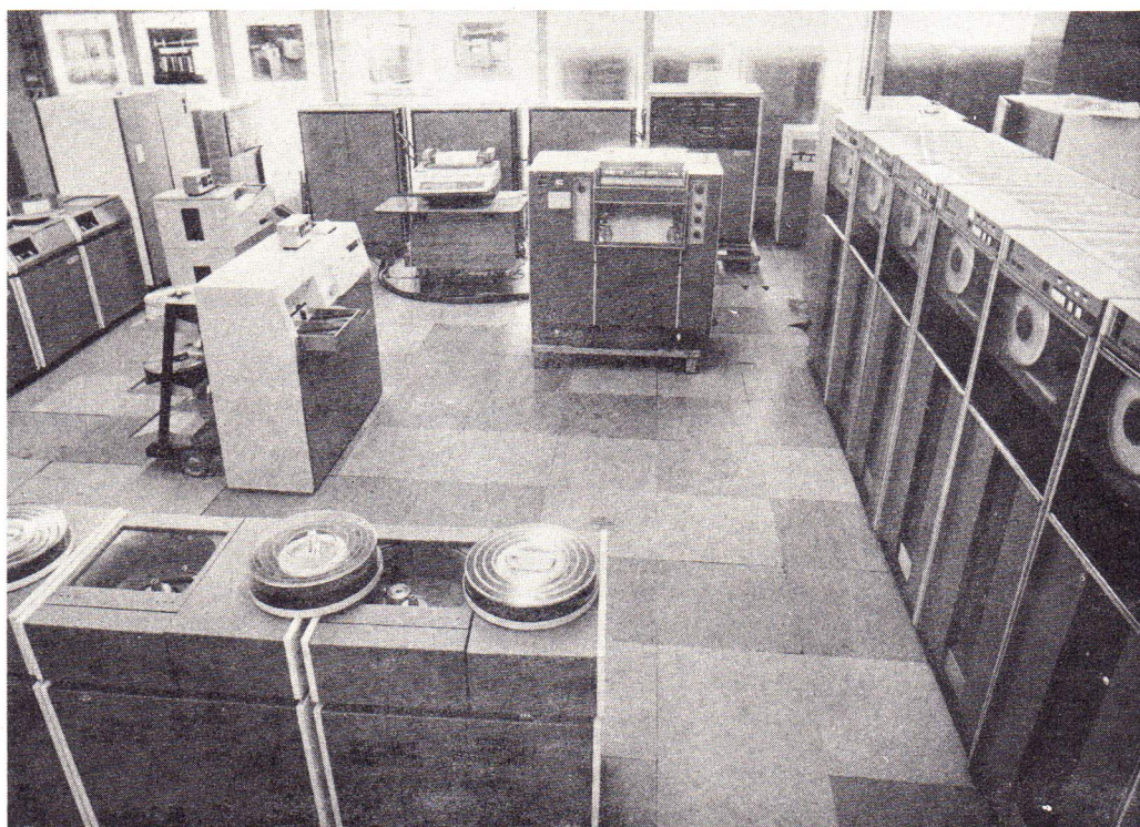
11. Uruchomiona maszyna cyfrowa R-32 o pojemności pamięci operacyjnej 1024 k.b. po eksploatacji wstępnej w zestawie, przygotowana do przekazania odbiorcy
