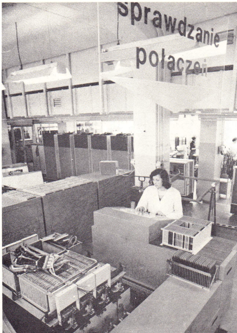
8. Pomimo stosowania pół-automatycznego owijania i dużej uwagi monterów przy wykonywaniu tej pracy, niezbędne jest sprawdzenie połączeń na skomplikowanym urządzeniu, jakim jest przedstawiany tester
