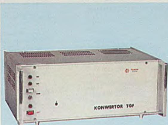
Konwerty TGF zwany również Urządzeniem Przekształcania Sygnałów Telegraficznych (UPSTG) stanowi część systemu transmisji danych małej szybkości do 200 bitów/s.
