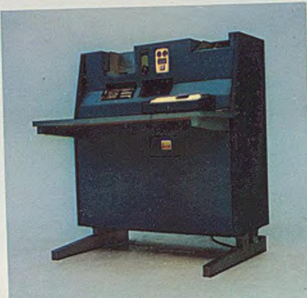
Alfanumeryczna sprawdzarka kart EC-9018 przeznaczona jest do sprawdzania danych wydzielanych na kartach 80-kolumnowych przeznaczonych dla maszyn cyfrowych JS EMC.
