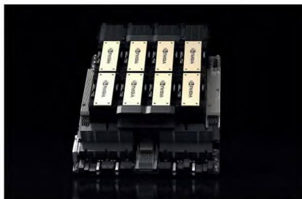
Jednostka graficzna NVIDIA H200 Tensor Core GPU – pamięć 141 GB, przepustowość pamięci 4,8 TB/s, teoretyczna wydajność FP84 petaFLOP, TPD do 1000 W
