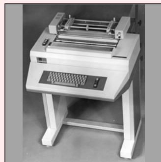
30. Terminal konwersacyjny DZM-180 KSR 1975-1982
