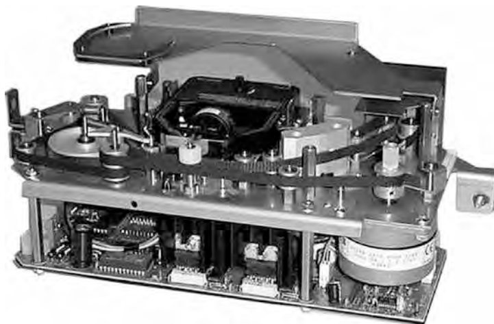
106. Mechanizm kasownika z elektroniką
