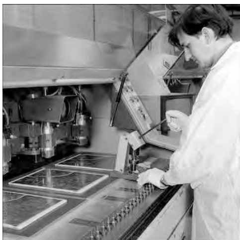
93. Obsługa wiertarki wielowrzecionowej, wiercenie otworów w obwodach drukowanych
