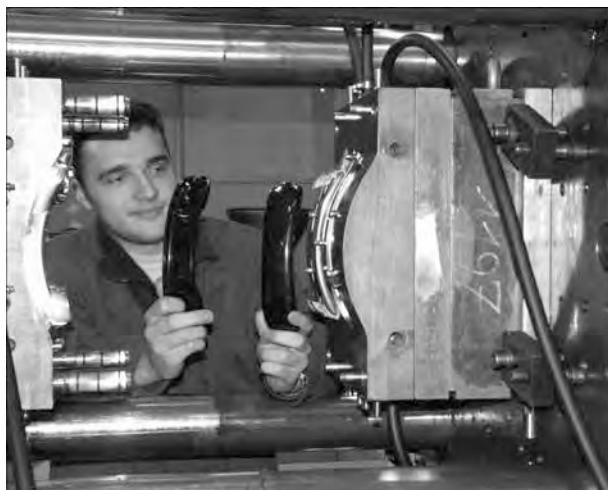
94. Obsługa wtryskarki do tworzyw termoplastycznych, wtrysk elementu słuchawki aparatu telefonicznego
