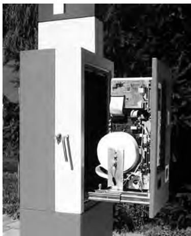
104. Parkometr, mechanizm z elektroniką
