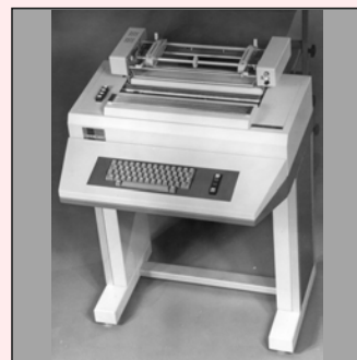
30. Terminal konwersacyjny DZM-180 KSR 1975-1982
