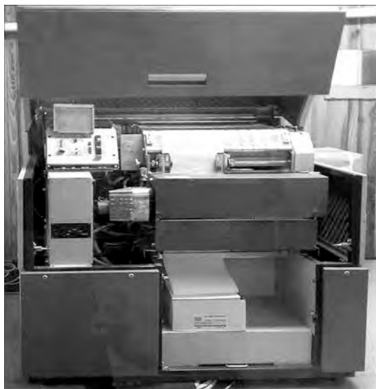
67. Drukarka wierszowa DW-402 w Biurze Informatyki ZME „EMIT” w Żychlinie. Zdjęcie wykonano w 2008 r. Drukarkę wyprodukowano w 1989 r., służyła do 2011 r., nadal sprawna, lecz wycofana z powodu zmiany systemu informatycznego
