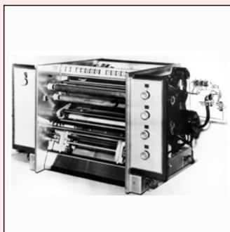
19. Mechanizm 666/V3 szybkiej drukarki wierszowej 1970-1990
