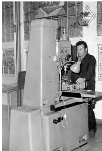
75. Narzędziowiec Ryszard Cieślak pracuje na wytaczarce współrzędnościowej firmy SIP (Szwajcaria)
