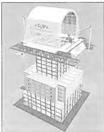
Rys. 5. Schemat zautomatyzowanego systemu wznoszenia budynku T-UP [13]
