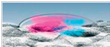
Konwencjonalny atrament barwnikowy, którego cząsteczki wnikają w głąb struktury papieru i są rozpuszczalne w wodzie
