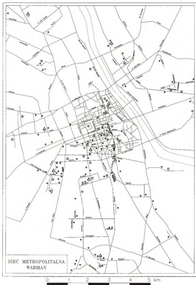
Rysunek 1. Rozmieszczenie jednostek naukowych i akademickich w centralnej części Warszawy. Na mapie zaznaczono orientacyjnie lokalizację węzłów (trójkąty) i koncentratorów (kwadraty) sieci WARMAN.
