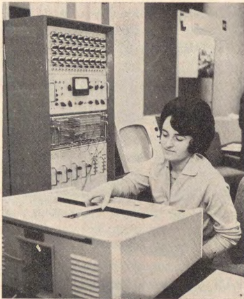
Rys. 15.3. Uniwersalna maszyna analogowa ELWAT-1 w wykonaniu Zakładów Elwro — 1967 r. (fot. CAF — Rosiak)
