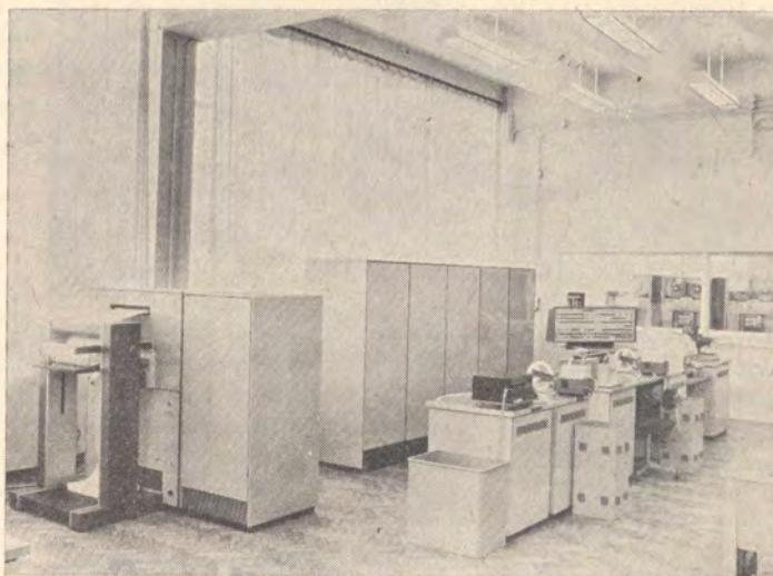
Rys. 15.7. Uniwersalna tranzystorowa maszyna cyfrowa o budowie modułowej, typu ZAM-41, przeznaczona do przetwarzania danych, wyposażona m.in. w stacje pamięci taśmowej i drukarkę wierszową (szybkość 40 000 operacji na sekundę)
