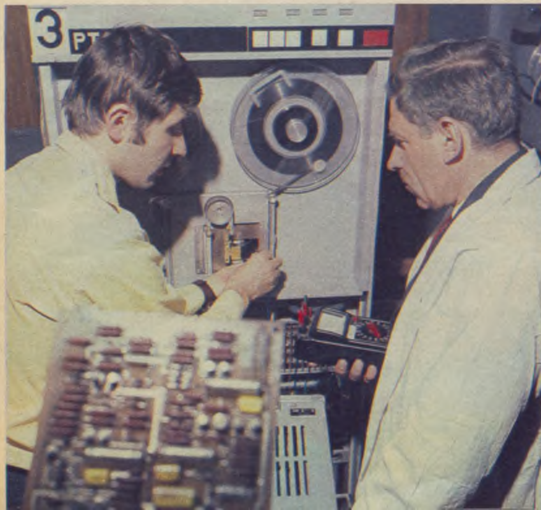
Pamięć taśmowa PT-3. Konstrukcja Instytutu Maszyn Matematycznych. Znajdzie powszechne zastosowanie w komputerach serii RIAD i ODRA-1305. Pamięć ta spełnia warunki zawarte w międzynarodowych normach i została przyjęta przez komisję ekspertów RWPG do seryjnej produkcji. Nowoczesne posiadania techniczne pamięci PT-3 posiadają kilka patentów. Fot. IMM
