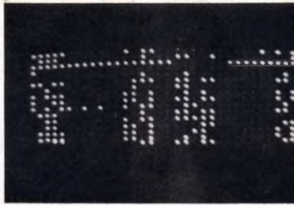
Fot. 4. 16 liczb zero-jedynkowych, pamiętanych w jednej z rur ręciovych, widocznych na ekranie synchroskopu pulpitu manipulacyjnego (każda z liczb składa się z 36 znaków).
