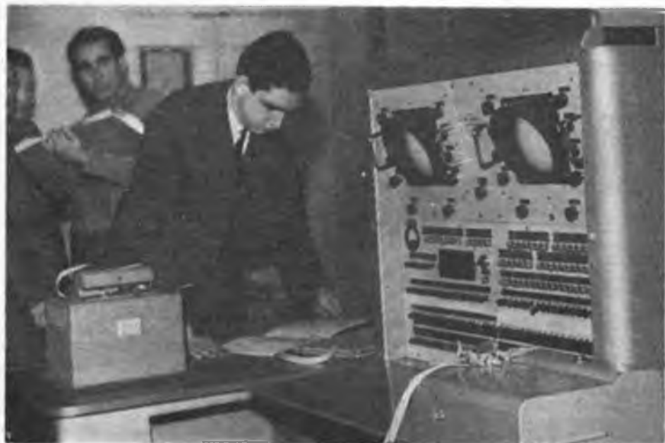
Stożek operatora w maszynie ZAM-2. Na pierwszym planie wyjście taśmowe (reperforator), dalej walciki (krytyk taśmy).
