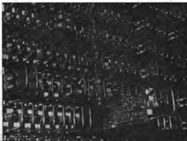
Z takich elementów (zwanych panelami) składają się rejestry maszyn XYZ i ZAM-2.
