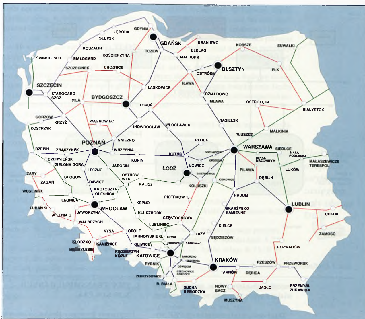
Rys. 1. Przewidywana budowa kablowych linii światłowodowych w sieci telekomunikacji PKP. Oznaczenia: — kablowe linie światłowodowe przewidziane do zbudowania do końca 1996 r., — kablowe linie światłowodowe przewidziane do zbudowania w latach 1997-2000, — kablowe linie światłowodowe przewidziane do zbudowania w latach 2001-2004.
