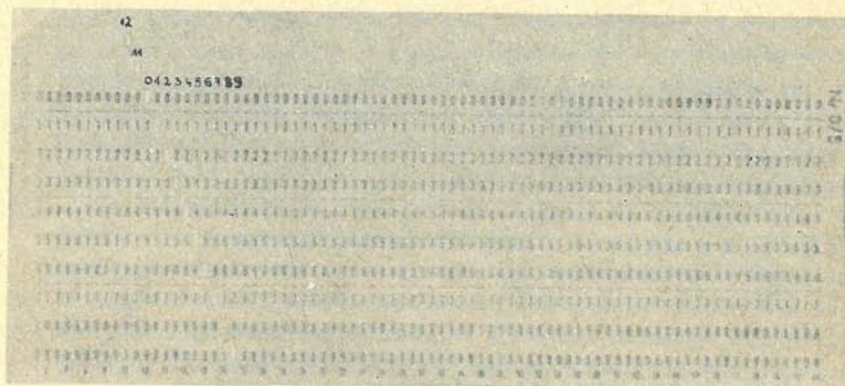
Rys.5.2 Karta perforowana uniwersalna 80-kolumnowa.
