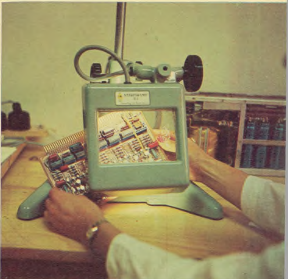
Pod szkłem powiększającym wykrywa się błędy montażu
