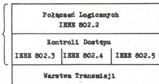
Rys. 2. Zależności pomiędzy Modelem OSI/ISO a standardami IEEE 802 Fig. 2. Relations between OSI/ISO Reference Model and IEEE 802 standards
