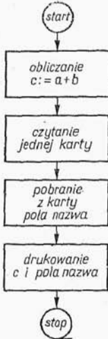
Rys. 3. Schemat blokowy fragmentu programu o podsieci liniowej
