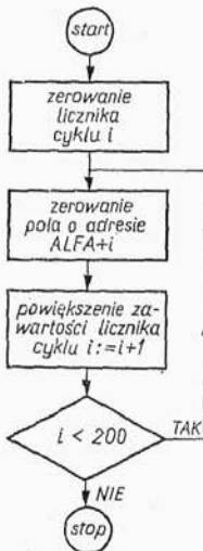
Rys. 5. Schemat blokowy fragmentu programu o podsieci z cyklem
