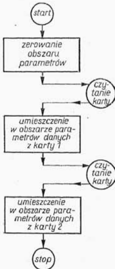
Rys. 7. Schemat blokowy fragmentu programu o podsieci z podprogramami
