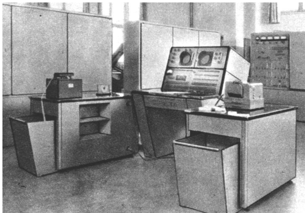
Rys. 2 Komputer ZAM2, poprawiona wersja komputera XYZ produkowana w IMM
