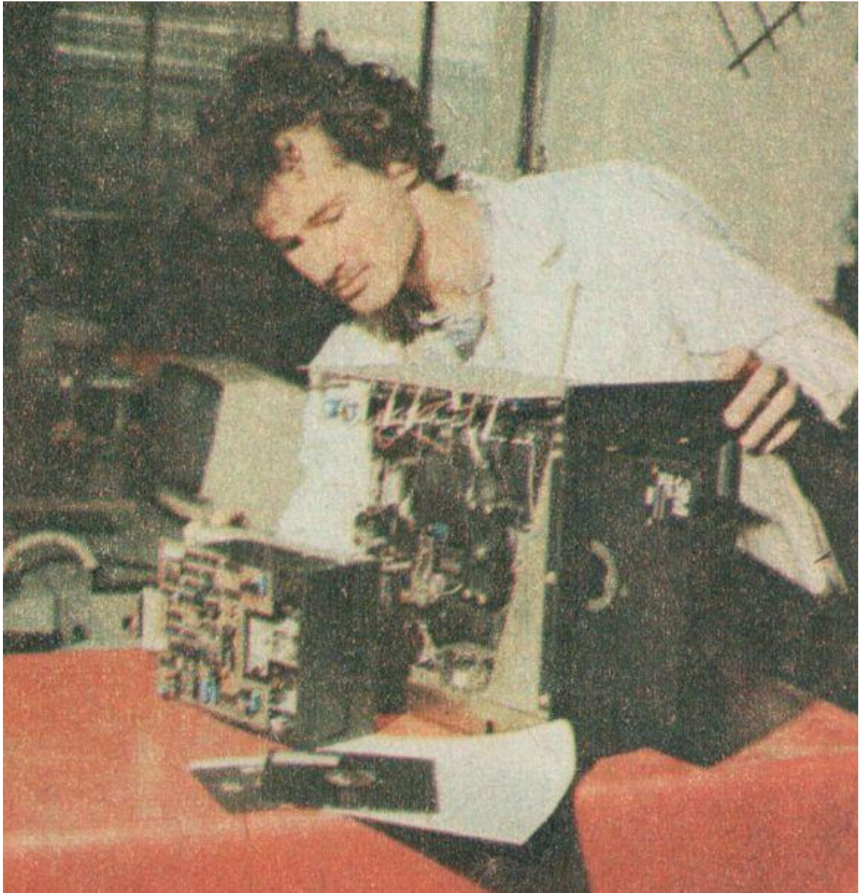
Pracownik KFAP prezentuje dwie generacje stacji dyskietek - duża 8 calowa PLx 45.D - ważąca 10 kg oraz mała 5 1/4 cala ED 501 - "zaledwie" 1,5 kg Ilustracja z "Młody Technik" nr 9/1986
