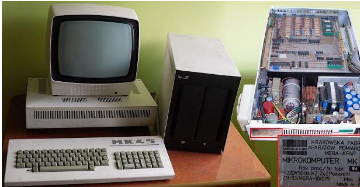
Mikrokomputer MK 45 na biurku, oraz po otwarciu obudowy. zestaw: myvimu.com wnętrze: 8bit.yarek.pl
