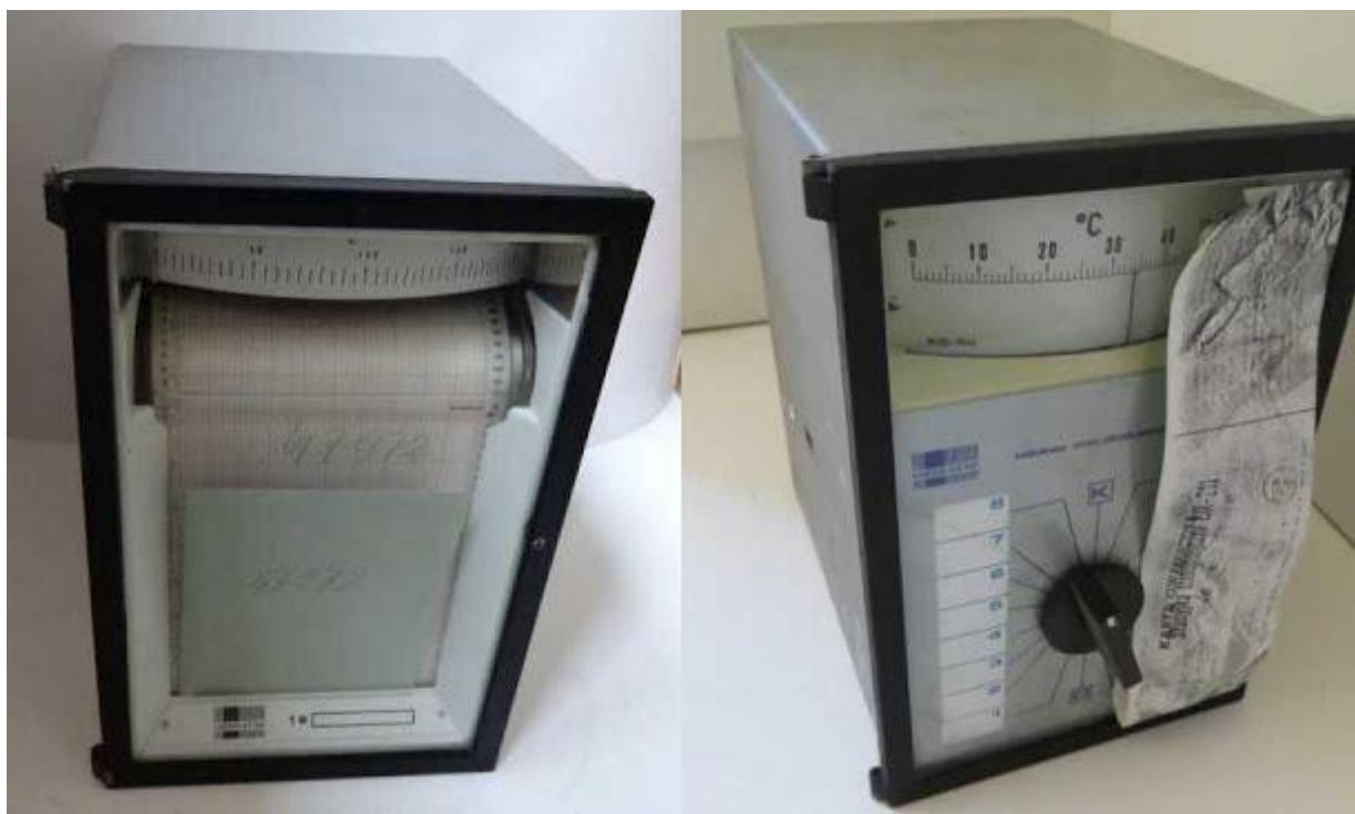
Urządzenia pomiarowe produkowane w latach 70-tych: Rejestrator elektryczny NSK12eVQ MERA-KFAP Miernik wielomiejskowy - stacyjka termometryczna ESI 211 Zdjęcia ze strony: el-kan.pl
