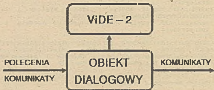
Fys 1. Obiekt dialogowy przetwarza komunikaty i polecenia Systemu, ViDE-2 korzysta z danych zawartych w standardowych strukturach obiektu dialogowego.
