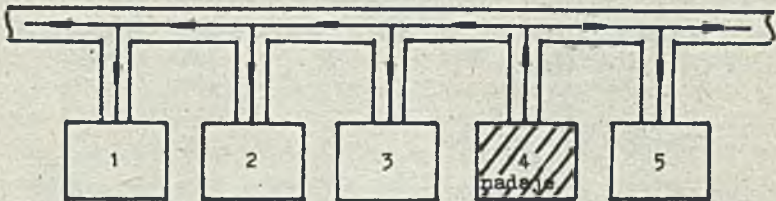
Rys. 1. Protokół dostępu CSMA/CD powoduje, że jedna stacja nadaje a reszta odbiera jednocześnie oczekując na uzyskanie dostępu do sieci
