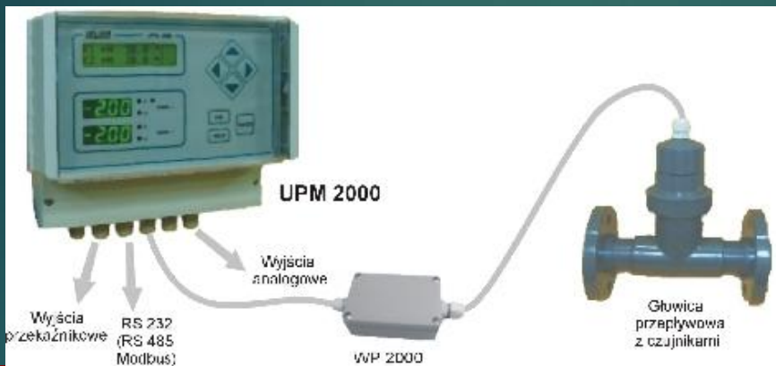
Przemysłowy zestaw do pomiaru pH, z przetwornikiem mikroprocesorowym (pH-metr przemysłowy)
