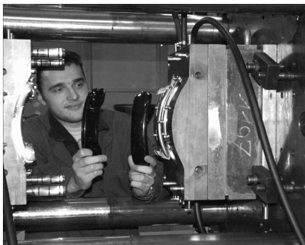
100. Obsługa wtryskarki do tworzyw termoplastycznych, wtrysk elementu słuchawki aparatu telefonicznego
