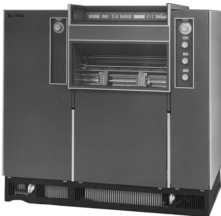
10. Drukarka wierszowa DW-3/EC-7033 o prędkości wydruku 1100 wierszy na minutę, opracowana przy współpracy z Instytutem Maszyn Matematycznych w Warszawie z udziałem konstruktorów ZMP „Mera-Błonie”, wytwarzana w latach 1974-1990
