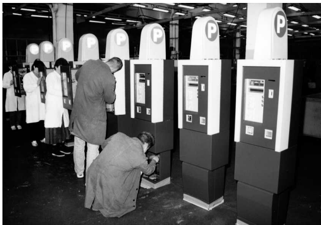
107. Montaż parkometrów dla m.st. Warszawy
