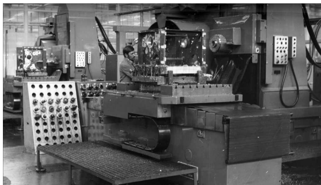
68. Obróbka korpusu mechanizmu drukarki w centrum obróbczym H6B firmy Mitsui-Seiki
