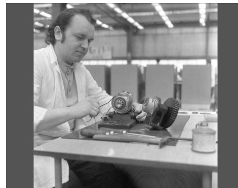
272. Montaż zespołu sprzęgła drukarki Oddział w Siedlcach
