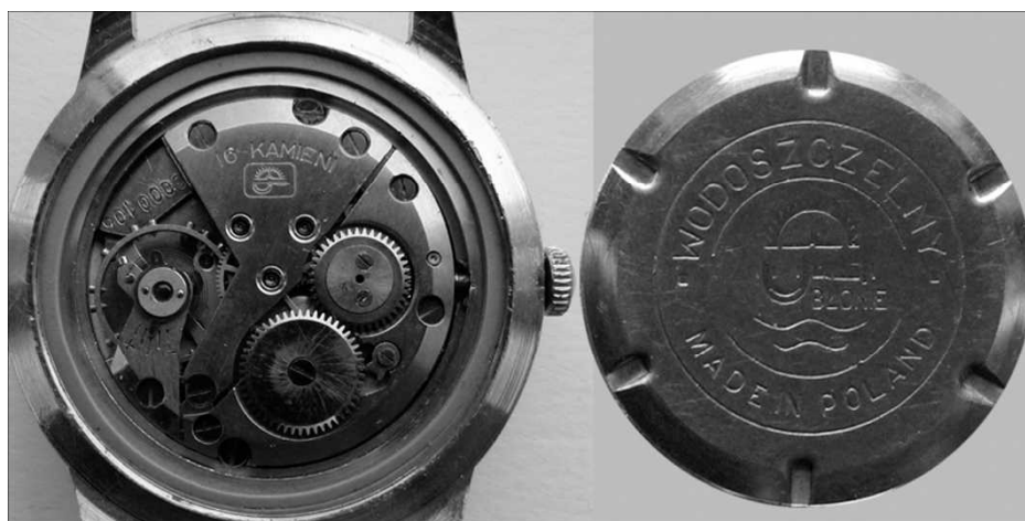
44. Zegarek (z kolekcji Stanisława Kordylewicza) zmontowany z części wyprodukowanych w ZMP, płyta nr 0000106, na mostku przekładni chodu i wieczku koperty znak zakładu
