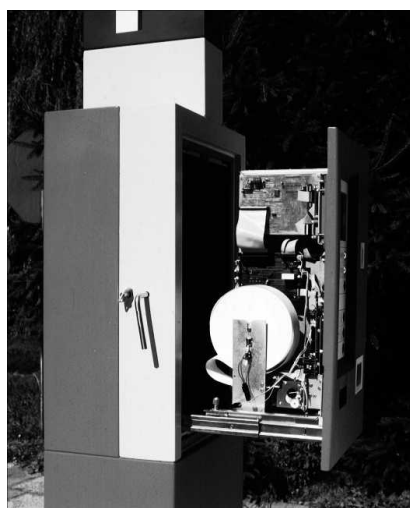
110. Parkometr, mechanizm z elektroniką
