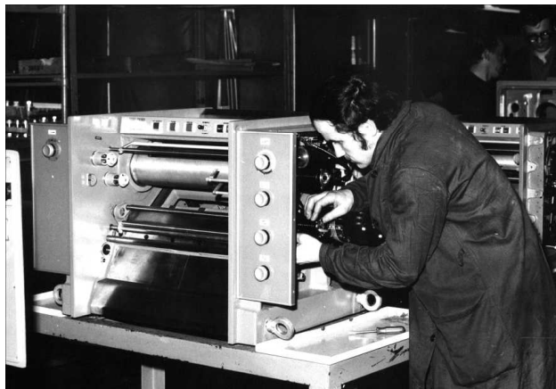
64. Montaż mechanizmu 666/V3 szybkiej drukarki wierszowej
