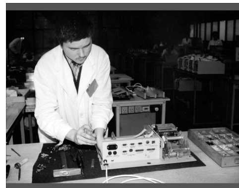
380. Kontrola zwijacza taśmy drukarki fiskalnej
