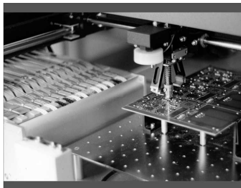
378. Półautomat do montażu powierzchniowego pakietów elektroniki
