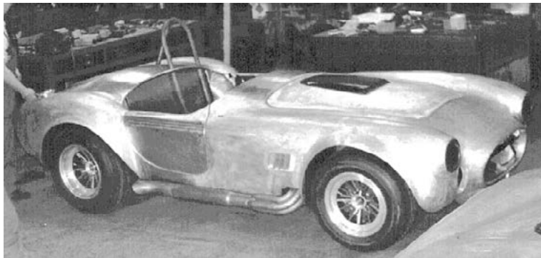
Fotografia 19. Nadwozie samochodu wykonane z modelu wzorcowego
