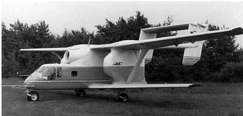
Fotografia 5. Samolot rolniczy o napędzie odrzutowym – M-15 (BELFEGOR)
