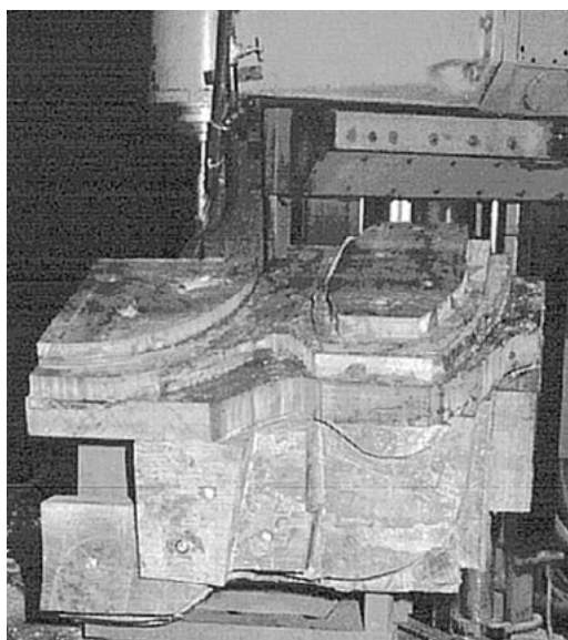
Fotografia 16. Master model przed obróbką na obrabiarce NC
