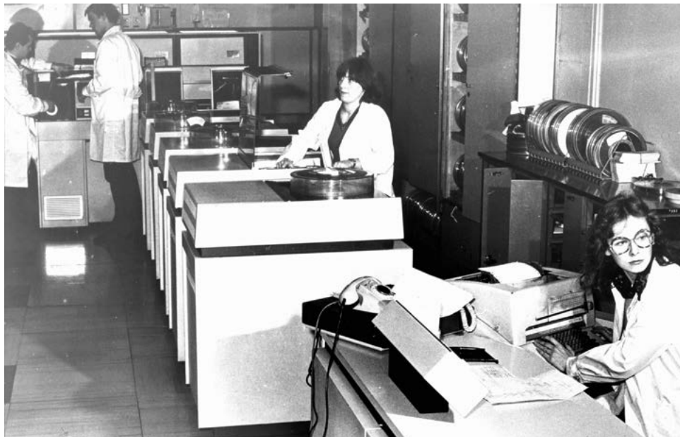
Fotografia 1. CIBEH-ICL System 4-50 konsola i jednostki dyskowe 7,5 Mb, w głębi czytnik taśmy papierowej i jednostka centralna
