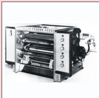
19. Mechanizm 666/V3 szybkiej drukarki wierszowej 1970-1990
