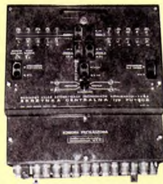
System automatyzacji przenośników taśmowych PUMA
