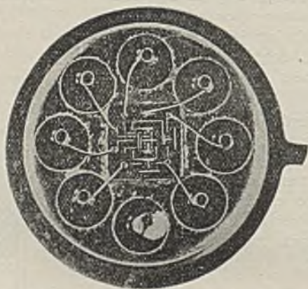
Mikromoduł jako obwód scalony na płytce półprzewodnikowej
