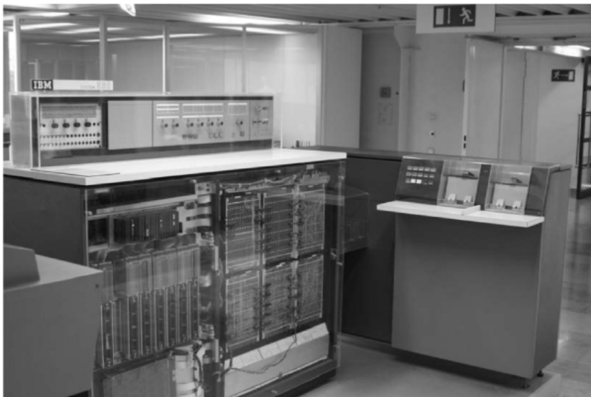
IBM System/360-20 – младшая модель серии (ноябрь 1964). Справа на фото – устройство подготовки данных на перфокартах MFCM
