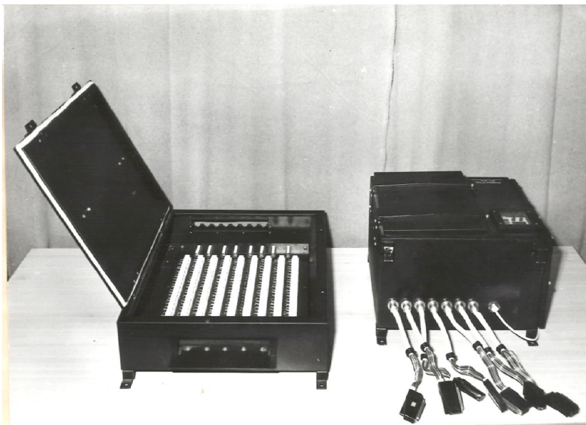
Rys. 3 Koncentrator danych KD02 wraz ze skrzynką połączeń zewnętrznych (do zacisków skrzynki połączeń były dołączane kable od czujników). Skrzynka połączeń była sprzężona z Koncentratorem KD02 poprzez widoczne kable ze złączami 50-krotnymi.
