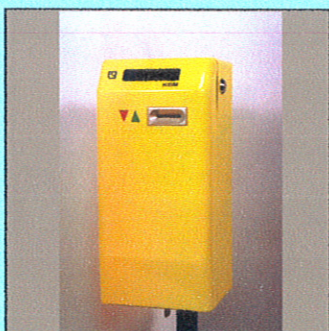
62. Kasownik biletów ze ścieżką magnetyczną 1996-2002
