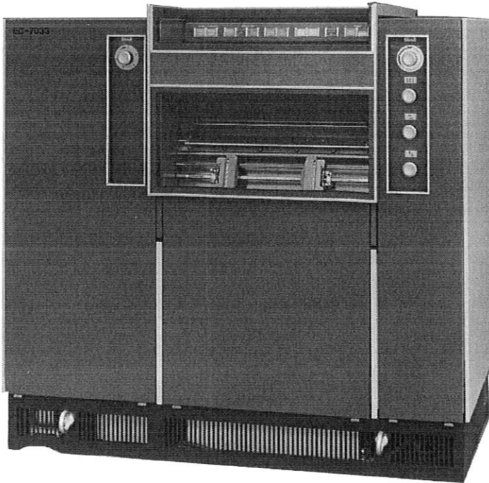
10. Wizerunek drukarki wierszowej DW-3/EC-7033 o prędkości wydruku 1100 wierszy na minutę, opracowanej przy współpracy z Instytutem Maszyn Matematycznych w Warszawie z udziałem konstruktorów ZMP „Mera-Błonie”, wytwarzanej w latach 1974-1990
