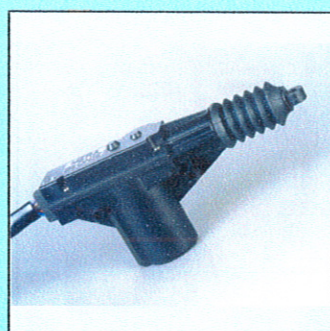
57. Siłownik zamka centralnego samochodu 1994-2003
