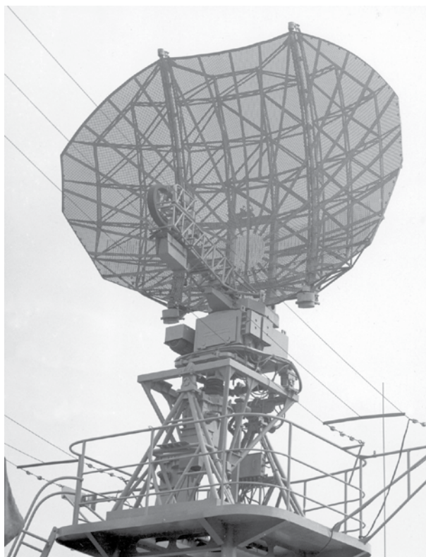
Antena radaru okrętowego N 25 na platformie kompensującej przechył okrętu
