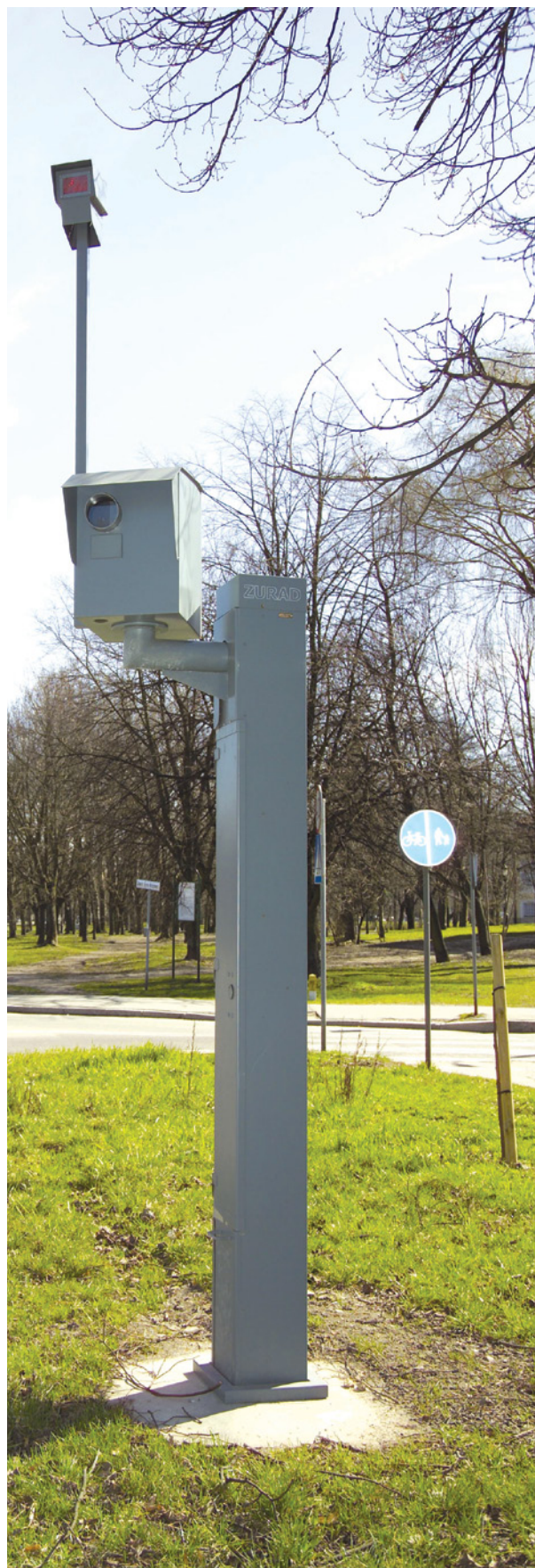
FOTORAPID w wersji stacjonarnej z lampką błyskową pozwalającą fotografować w nocy
