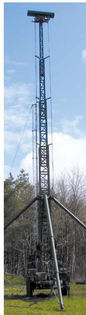
Maszt teleskopowy z anteną radaru RM-100
