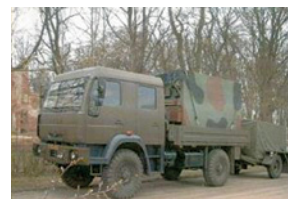
Zautomatyzowany Wóz Sztabowy ZWS-10S (ZWS-20, ZWS-10). Samochód Star 944DK, nadwozie kontenerowe typu 890, przyczepa D622 z zespołami prądotwórczymi
