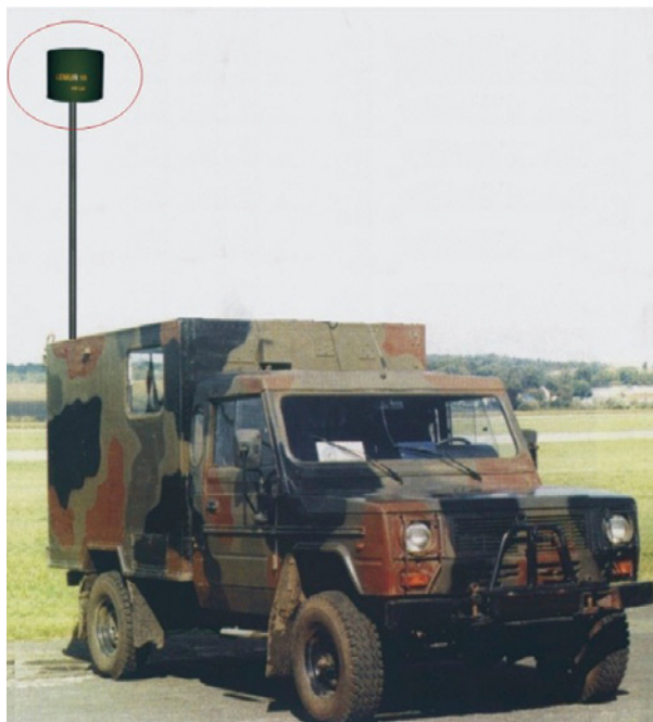
Lemur-10 zainstalowany na pojeździe rozpoznania elektronicznego
