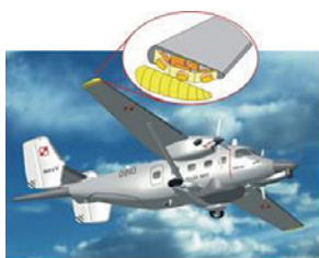
Antena i przedwzmacniacz urządzenia Lemur-10 umieszczone na końcach skrzydeł samolotu
