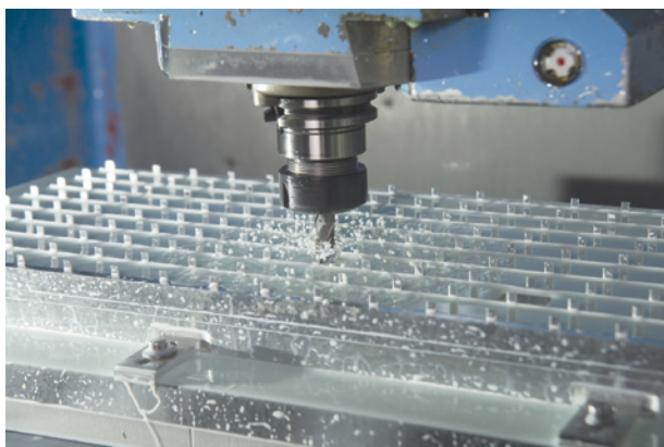
Obróbka elementu anteny radiolokacyjnej
