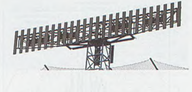
Rys. 8.12. Widok apertury anteny AFF-600
