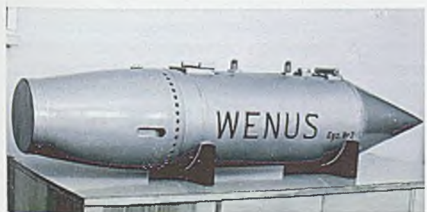
Rys. 8.28. Imitator celu powietrznego WENUS
