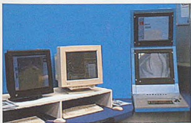
Rys. 10. 25. Konsole systemu LINK-11, od lewej – konsola symulatora łącza LINK, w środku – konsola KSL-1100 w wersji COTS, po prawej – okrętowa wersja konsoli KSL-1100
