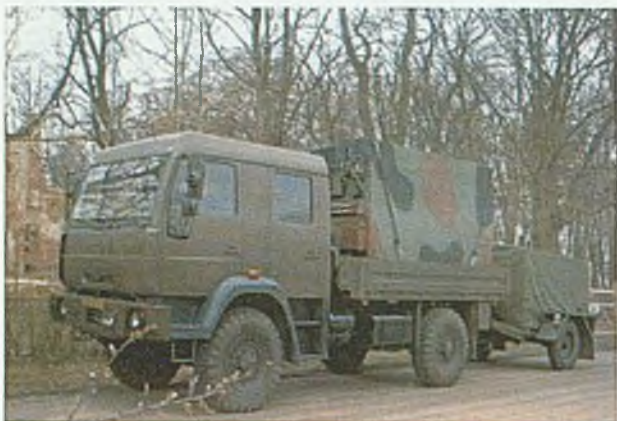
Rys. 10.16. Zautomatyzowany Wóz Sztabowy ZWS-10S (ZWS-20, ZWS-10) samochód STAR 944DK, nadwozie kontenerowe typu 890, przyczepa D622 z zespołami prądotwórczymi
