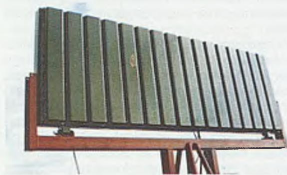
Rys. 8.9. Widok apertury anteny AFF-20
