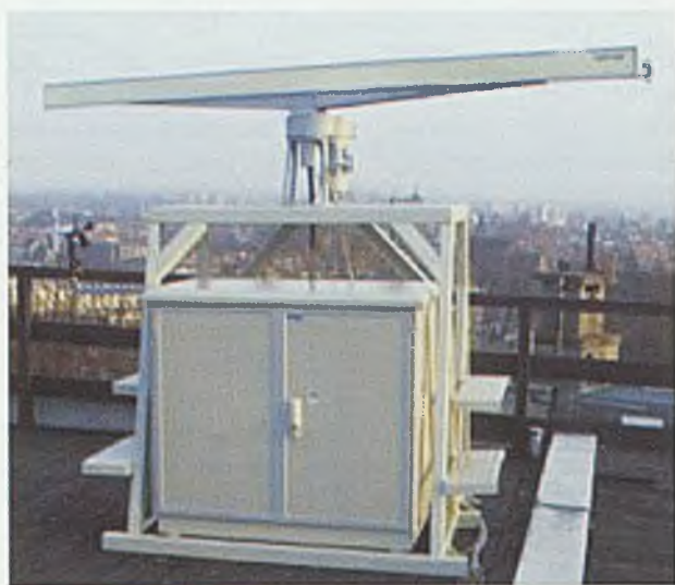
Rys. 4. 6. Jednostka nadawczo-odbiorcza MSR-20 na stanowisku pomiarowym
