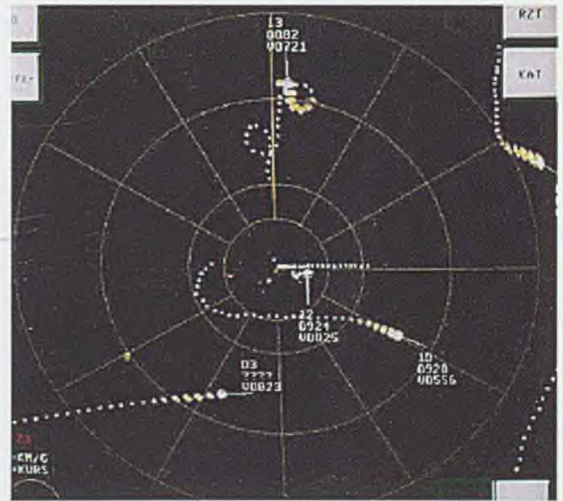
RYS. 10.4 Zobrazowanie sytuacji powietrznej - w kolorze żółtym zobrazowane są echa analogowe ze sztuczną poświatą, białe kropki oznaczają historię tras
