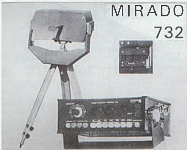
Rys. 8.17. Radarowy miernik prędkości nowej generacji MIRADO 732
