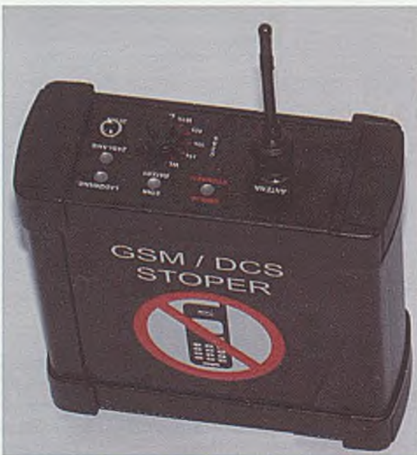
Rys. 8.25. Widok urządzenia do zakłócania odbiorników telefonów komórkowych
