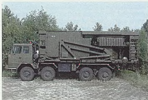
Rys. 3.28. Trójwspółrzędny radar średniego zasięgu w pozycji transportowej
