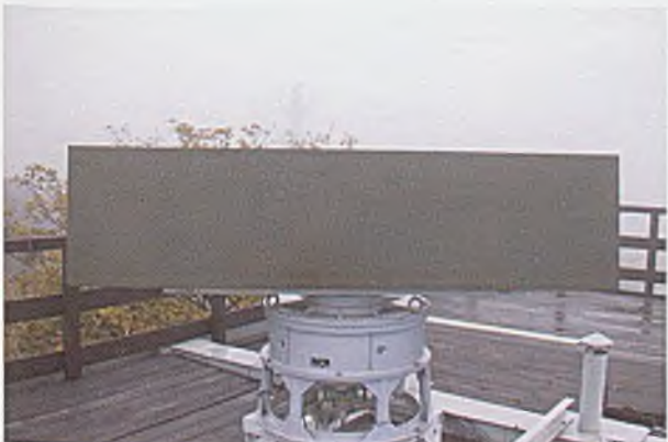
Rys. 5.6. Widok osłony struktury promieniującej anteny
