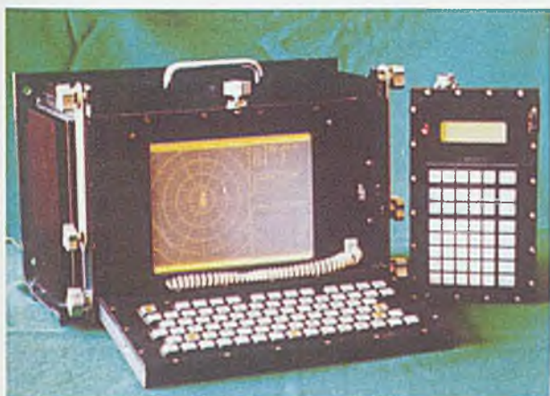
Rys. 10.11. Terminal TDR –10 widoczny na pierwszym planie (opracowanie firmy ELTIS Sp. z o.o.)
