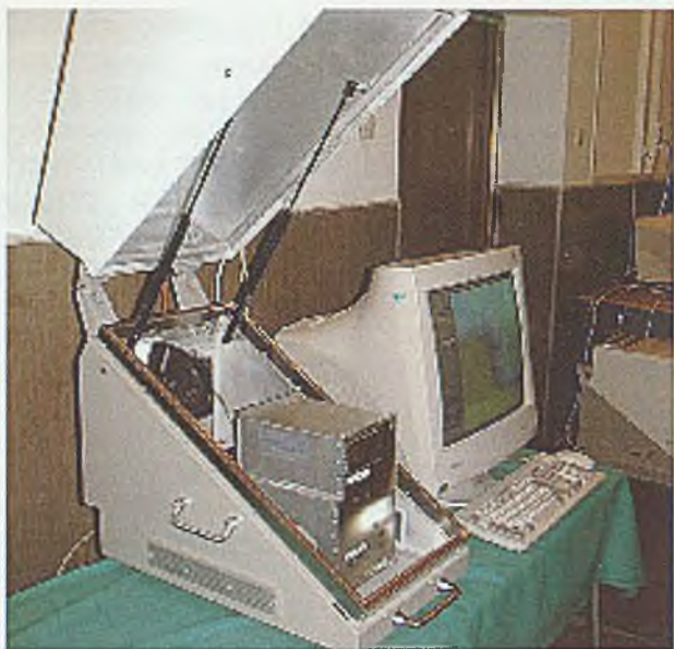
Rys. 10.26. Komputer w obudowie „Tempest”
