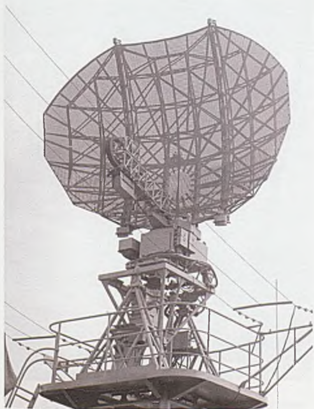
Rys. 5.1. Antena radaru okrętowego N-25 na platformie kompensującej przechyły okrętu
