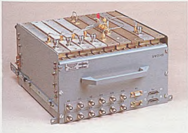
Rys. 7.8. Blok wzbudzająco-odbiorczy z czterokanałowym odbiornikiem
