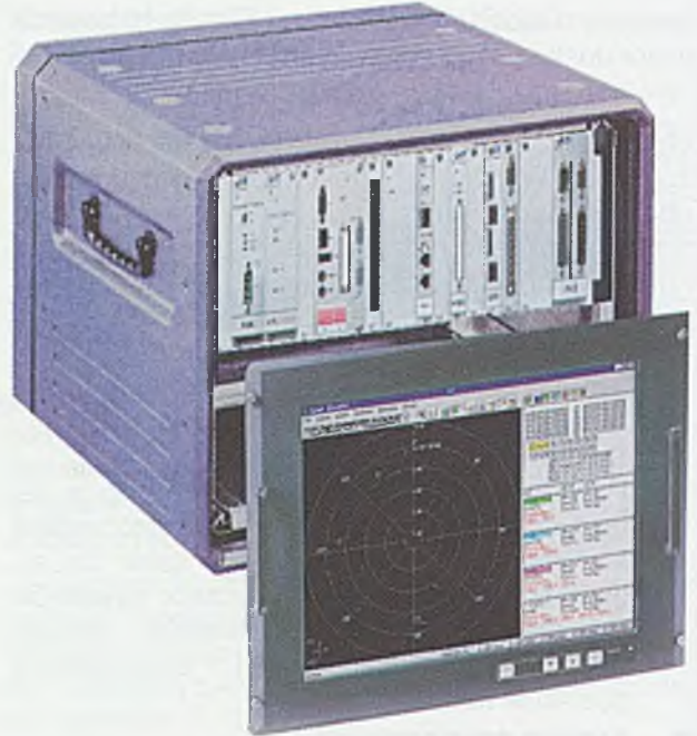
Rys. 6.12. System cyfrowej obróbki sygnału z monitorem LCD
