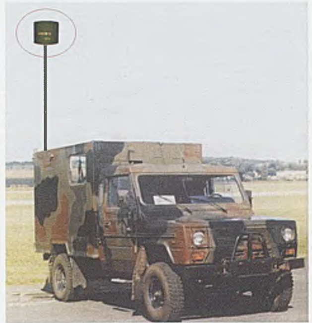
Rys. 6.8. LEMUR-10 zainstalowany na pojeździe rozpoznania elektronicznego
