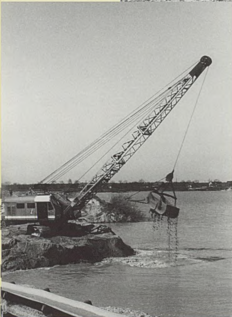
▲ Koparka KU-1206 z wysięgnikiem kratowym i osprzętem zgarniakowym
