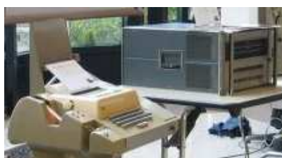
Fig.2 Minikomputer HP2114B z teledrukarką (teletype) ASR-33
