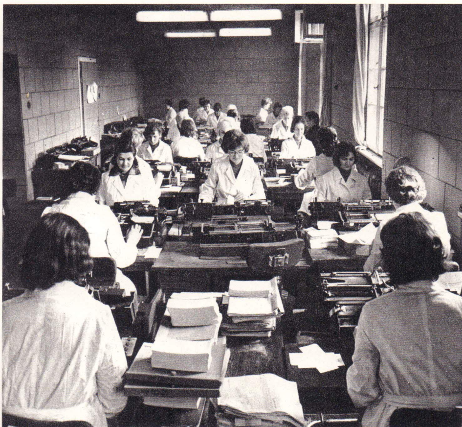
OTO DALSZE WAŻNE OGNIWO PRACY CBRPW: SPRAWDZARKI DOKONUJĄ KONTROLI KART WYDZIURKOWANYCH PRZEZ PERFORATORKI
