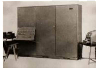
Odra 1002 to drugi komputer opracowany w zespole Jana Markowskiego. Jako prototyp lampowo – tranzystorowy wykonany w 1962 r. tylko w jednym egzemplarzu, nie wdrożony do produkcji ze względu na niskie parametry niezawodnościowe. Egzemplarz ten znajduje się w Muzeum Techniki w Pałacu Kultury w Warszawie.
