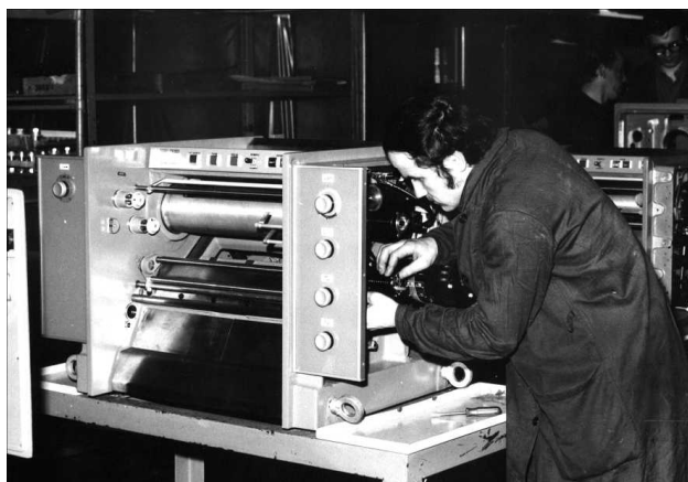
64. Montaż mechanizmu 666/V3 szybkiej drukarki wierszowej
