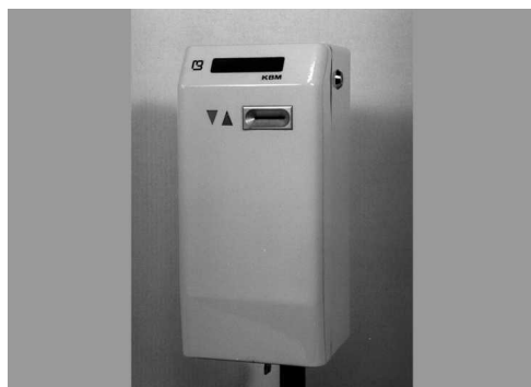
95. Kasownik biletów ze ścieżką magnetyczną
