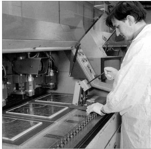
99. Obsługa wiertarki wielowrzecionowej, wiercenie otworów w obwodach drukowanych
