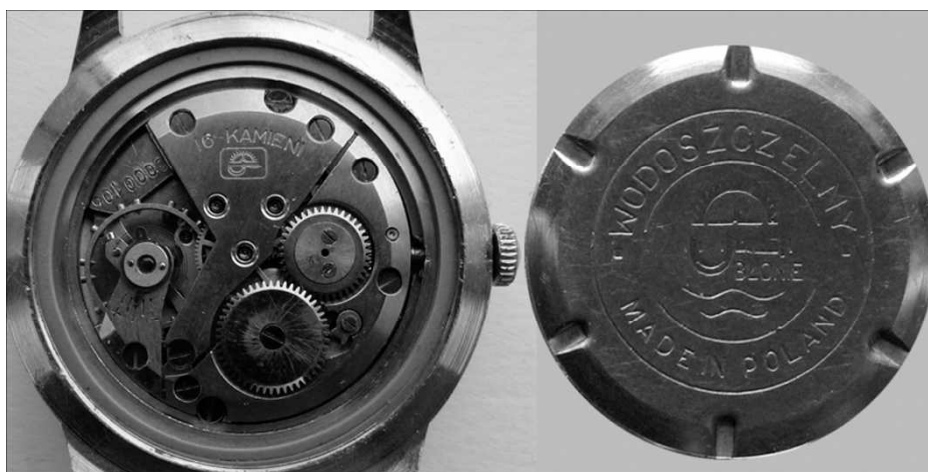
44. Zegarek (z kolekcji Stanisława Kordylewicz) zmontowany z części wyprodukowanych w ZMP, płyta nr 0000106, na mostku przekładni chodu i wieczku koperty znak zakładu
