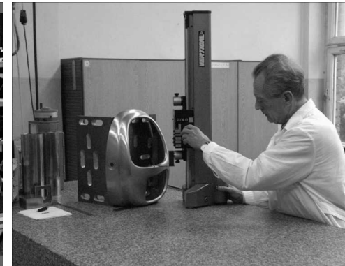
404. Kierownik Izby Pomiarów Stanisław Ciesielski sprawdza obudowę telefonu
