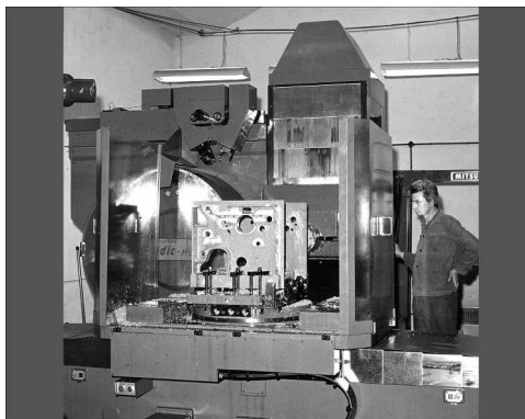
223. Obróbka korpusu mechanizmu drukującego
