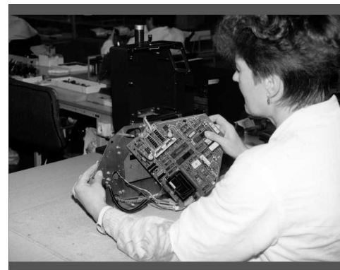
383. Montaż płyty elektroniki kasownika biletów
