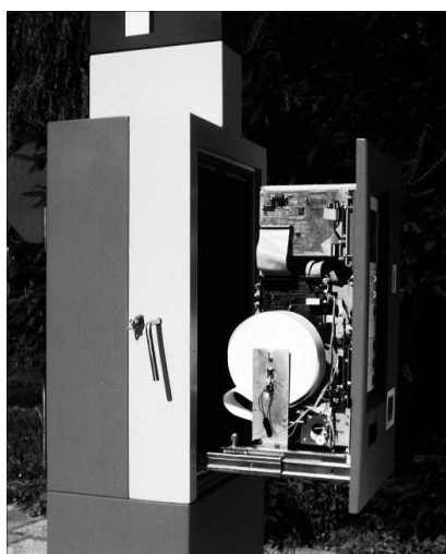
110. Parkometr, mechanizm z elektroniką
