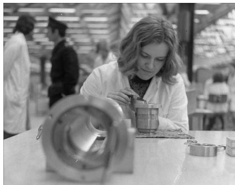
271. Montaż bębna emitera drukarki Oddział w Siedlcach
