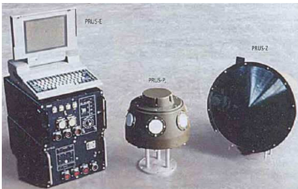
Rys. 6.13 Elementy zestawu PRUS. Po lewej: moduł analizujący PRUS-E, antena analizująca PRUS-P i antena celownicza PRUS-Z.
