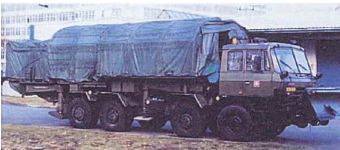
Rys. 6.8 Maszt antenowy urządzenia KRTP 86 (TAMARA), w stanie do transportu
